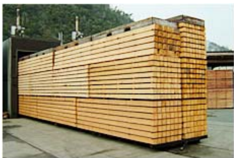
ヒノキ柱材の乾燥終了後、 MIZDAS®搭載乾燥機から出庫
