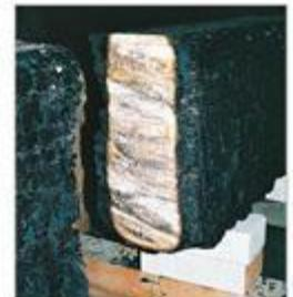
構造材の表面に形成された炭化層
