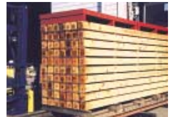
木材乾燥システムにより含水率15%以下に乾燥したスギ材
