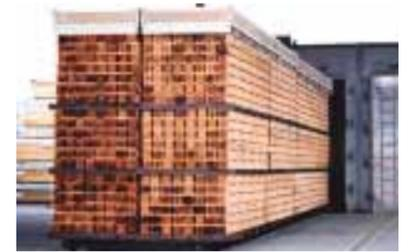
木材乾燥システムにより含水率15%以下に乾燥したスギ材
