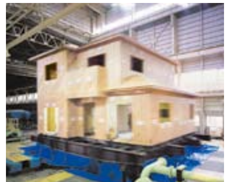
実物大の振動実験で耐震性を確認
