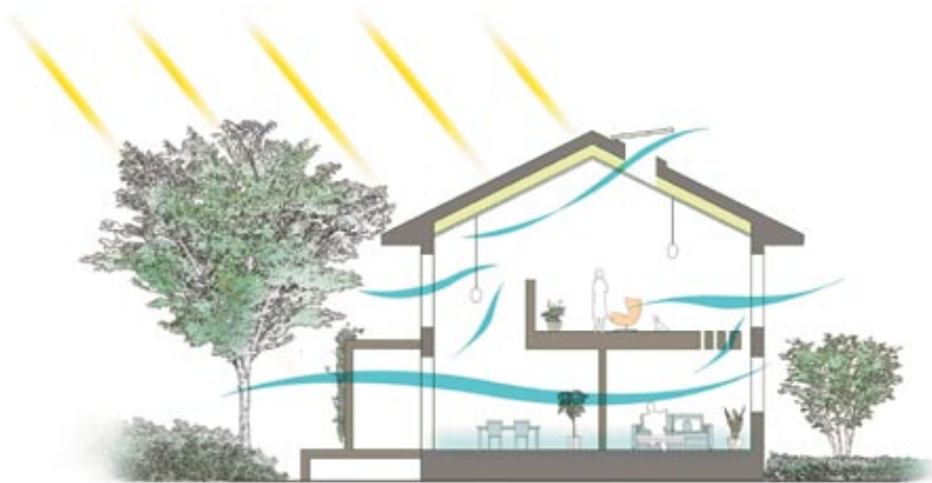
欄間や小窓、格子戸などを効果的に配置し、家の中に風の通り道をつくって夏の暑さを和らげる。
