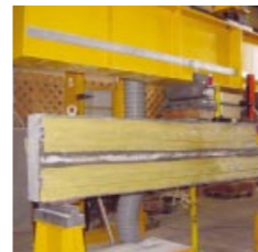
住友林業ホームテック(株) 帯鋼とアラミド繊維を使った基礎補強技術「スミリンARC(アーク)工法」
