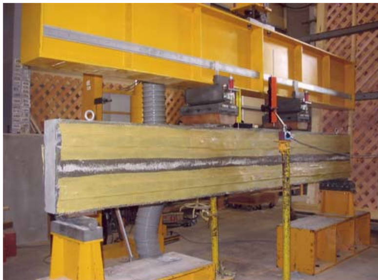
住友林業(株)・住友林業ホームテック(株) 帯鋼とアラミド繊維による補強実験
