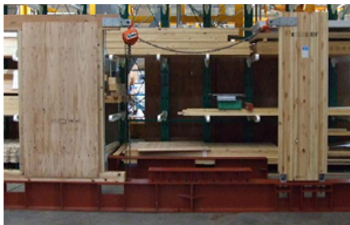
筑波研究所におけるBF構法の強度実証実験 (ビッグコラムと構造用合板の耐力比較)
