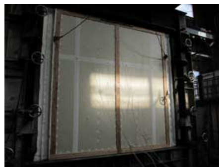
加熱45分時の試験体裏面（間仕切壁）
