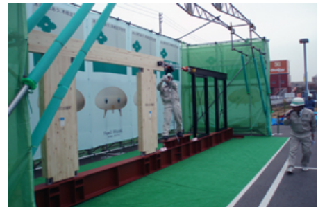
BFコラムと鉄骨の強度を比較する「引っ張り実験」 （山口会場 2010年11月開催）
