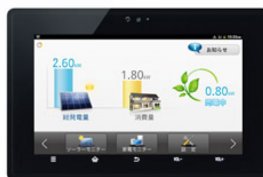
太陽光発電システムの運転状況
