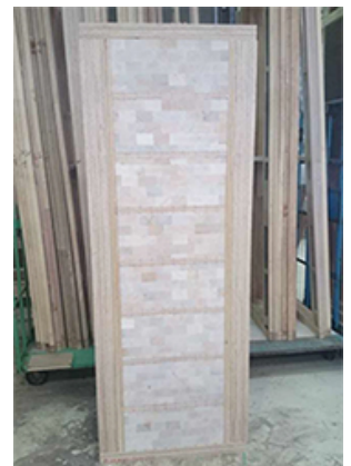
中央部分にバルサを充填した 扉内部の様子
