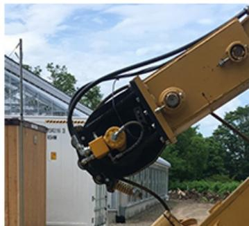
折り畳みタワーの先端につけたワイヤー張力調整装置(イジェクター)
