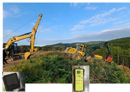
連結姿勢 リモコンで下の機械から操作し、上の機械
