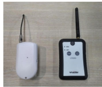
本実験で利用したLPWA子機 (左:ソニーのLPWA、右:LoRaWAN)
