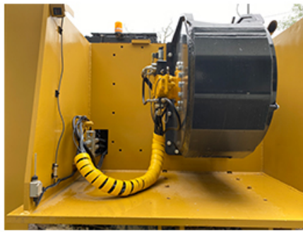
テザー背面に搭載されたウインチとワイヤー。250m のワイヤーが格納。 左側には拡張ウインチ搭載スペースあり。 将来追加でワイヤーを搭載するなどの拡張余地をもつ。
