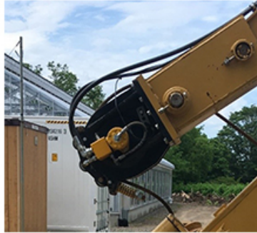
折り畳みタワーの先端につけたワイヤー張力調整装置(インジェクター)
