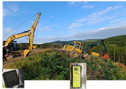
連結姿勢 リモコンで下の機械から操作し、上の機械 ではモニターで確認できる
