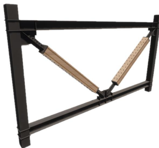
建物の架構骨組に組み込まれた KS 木質座屈拘束ブレース
