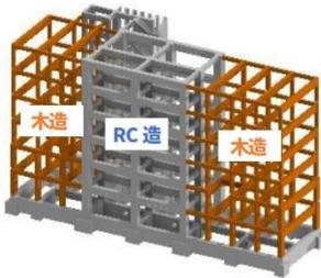
脱炭素社会の実現に向け中大規模建築で木造化・木質化への関心が高まり、木造とその他の構造を併用する混構造建築のニーズが増えています。
