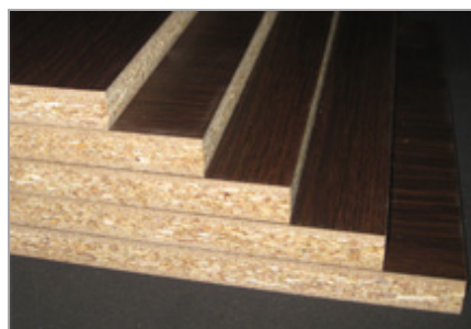
住友林業ホームテック（株）の リフォーム現場で発生した木くず を利用したパーティクルボード
