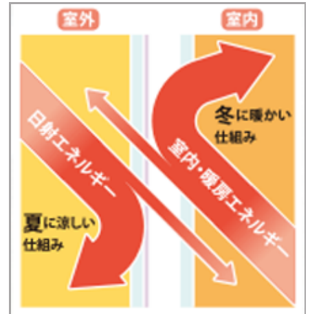
Low-Eガラスによる断熱イメージ
