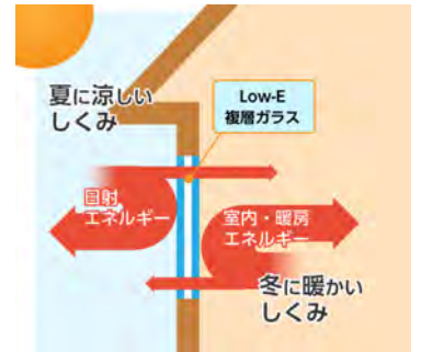
Low-Eガラスによる断熱イメージ
