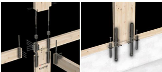
金属相互の接合「メタルタッチ接合」により堅固なラメン構造を実現
