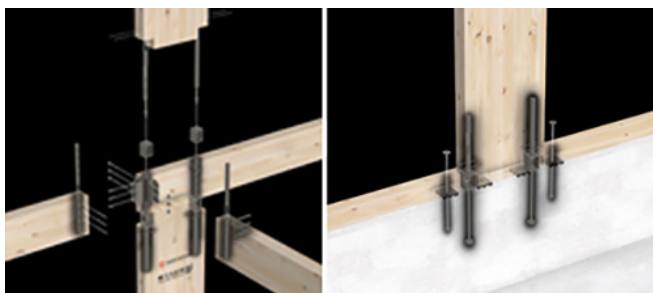
接合金物相互の「メタルタッチ接合」により堅固なラーメン構造を実現
