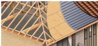
水平荷重に対して小屋全体で構面の剛性・耐力を確保する構造計画が必要
