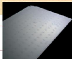
部屋の気温を安定させるのに利用できるのが蓄熱材だ。蓄熱には、顕熱方式と、潜熱方式がある。コンクリートやレンガなど、熱容量の大きなものに熱を蓄える顕熱方式に対し、潜熱方式では、蓄熱材が固体から液体に変わる際には熱を溜め続け、また、液体から固体に変わる際には熱を放出する。それぞれの温度は、蓄熱材の材料や配合によって自由に設定できる。「パッシブ・スミターマル」は床用蓄熱パネルで、暖房や日射などで部屋が暖められると中の蓄熱材が23℃で融け始め、熱を蓄えて部屋の温度の上がり過ぎを抑える。逆に部屋の気温が下がってくると19℃で固体に戻り、蓄えた熱を放熱する。このように20℃前後で蓄熱・放熱して、急激な温度の変化を抑え、快適な住環境を保つ。
