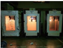
KITOTETUパネルと外断熱、通常の外断熱、グラスウール断熱の3タイプを設置し実験。蓄熱、結露、遮音の効果を測定。
