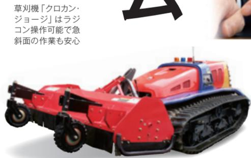
草刈機「クロカン・ジョージ」はラジコン操作可能で急斜面の作業も安心
