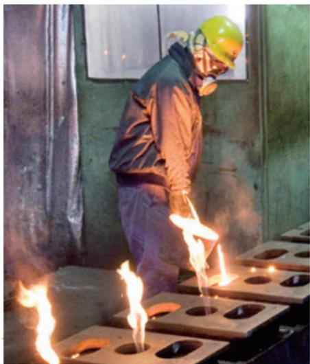
南部鉄器の溶解・造型作業。砂型に流し込まれる鉄の温度は1500度にも達する
