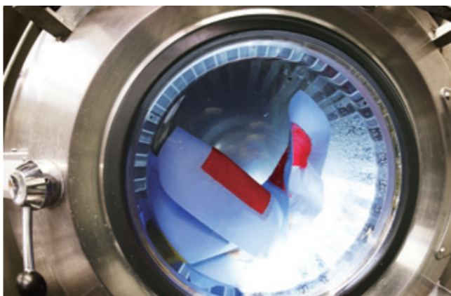
水中で疑似無重力状態を作る「無重力バランス洗浄機」
