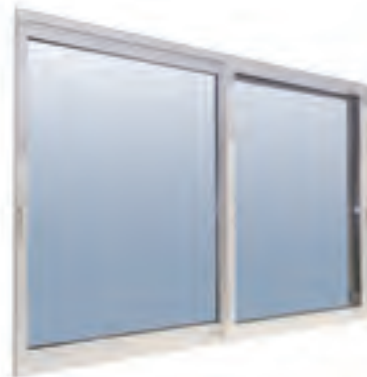
室外から見ると錠の位置が分かりにくいことも侵入犯を遠ざけるのにひと役買う。引違い窓の戸先錠は解錠・施錠の操作が簡単で分かりやすく、閉め忘れ防止に役立つ他、補助錠によって防犯性も高まっている
