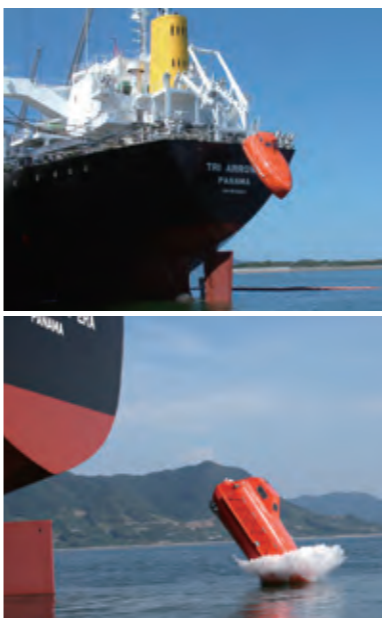
有人降下試験のデータを蓄積し完成した初の純国産自由降下式救命艇
