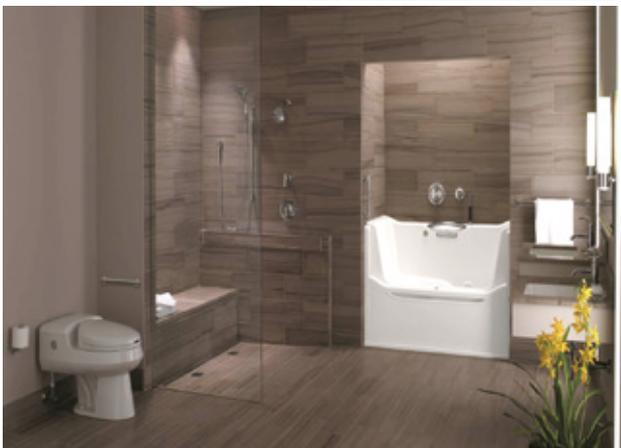
**[バリアフリー・シャワールーム]**段差やドアがなく連続して続く床、車椅子と同じ高さの便器・バス、手すりにはデザインを壊さず配置。落ち着いたニュートラルカラーは最近のトレンド、照明は明るく配慮。シニア市場は米国でも拡大
