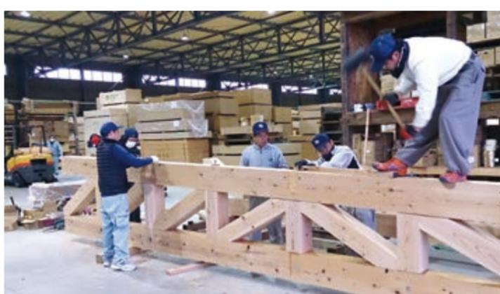
プレカット工場内の作業風景。金物接合のための端部を加工した後、出荷前にトラスに組み上げること現場の負担を軽減する
