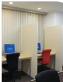
フラワーアレンジメントで使われる吸水性スポンジの吸音特性を建材に転用した、新しい吸音材。多孔質で、細かな網目状の3次元セル（空気層）\*が、従来の吸音材では難しかった中・低音もなめらかに吸音する。また空気の抜けが少ないため、遮音効果も併せ持つ。壁に貼り付けたり、パーティションとして使用するほか、オーディオルームの音響調整パネルなどにも利用される。
