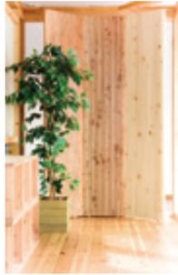
北海道産カラマツ・トドマツのボードに縦溝、直交溝を施し、3枚張り合わせた。溝に音を引き込み、音を跳ね返すことなく吸音する。また、中・低音域吸音の精度を上げるため、間にファイバーグラスの吸音材をはさんだ2層タイプもある。無垢材のやわらかな雰囲気とデザイン性を生かした「吸音可動式パーティション」が開発されている。
