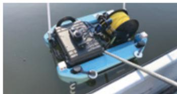
ダム点検用の水中ロボット (写真提供: 株式会社キュー・アイ)
