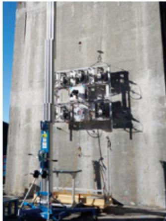
真空吸着を利用した壁面検査用ロボット (写真提供: 株式会社開発設計コンサルタント)
