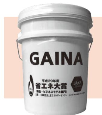
遮熱・断熱にプラスアルファの機能を持つ多機能性塗料。JAXAのH-IIロケット先端部に使用されている断熱技術を応用し、セラミックを建物の内外に施工できるよう開発された製品だ。主成分となるセラミックにより、暑さ・寒さ・結露などを解消するほか、ニオイや鳴き声、ペットの室内飼いで生じる住まいの悩みを解決してくれる。ニオイ対策では遠赤外線を効率的に放射することにより空気中の水分と反応し、ニオイ物質の浮遊を抑える。また、大学との共同研究で省エネ効果が証明されており、高騰する電気代を削減できる。有機溶剤などの危険物を使用しない水性の塗料のため、人にもペットにも安全だ。ローラーや吹き付けなど様々な方法で施工が可能で、200色以上の色合いにも対応できる。
