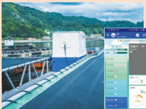
AI給餌機「餌ロボ」と給餌中の画面。餌ロボにソナーを搭載し、真鯛の群れがいる深度により給餌をコントロールする
