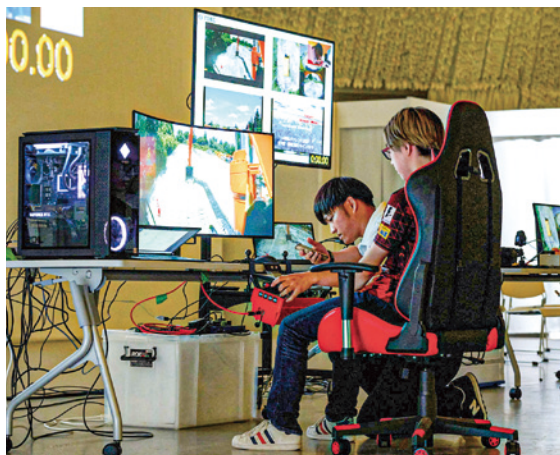
ARAV製の遠隔操作システムを設置した建設機械を遠隔地から操作する。油圧シヨベルで掘削した土をキャリアダンブに入れ目的地まで運ぶタイムトライアルで、掘削量が少ない、安全性に欠けるなどのマイナスポイントでは時間が加算される
